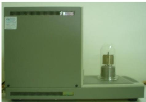
Figura 2.2.- Equipo TA Instruments modelo 2010 para DSC.
