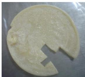
Figura 3.1.- Muestra AE112. La muestra fue cortada para FTIR, DSC y AFM.
