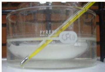
Figura 2.1.- Solución de HPC/PAAm con APS, MBAm y TEMED.
