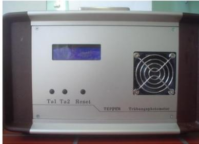
Figura 2.4.- Equipo Tepper modelo TP1 para turbidimetría.
