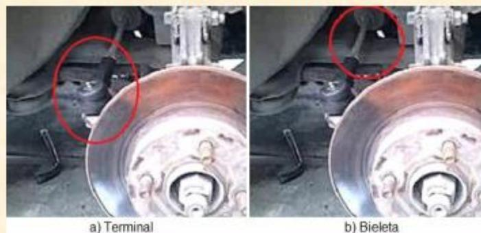
Figura 33. Componentes de dirección (Satelitaxi.S.C., 2021).
