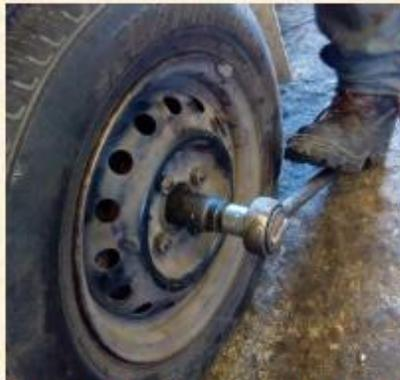
Figura 42. Forma de aflojar la tuerca central (Satelitaxi.S.C., 2021).
