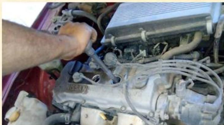
Figura 13. Atornillado de bujías (Satelitaxi.S.C., 2021).
