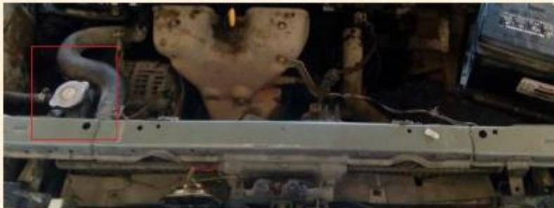
Figura 18. Tapa de llenado para el refrigerante (Satelitaxi.S.C., 2021).
