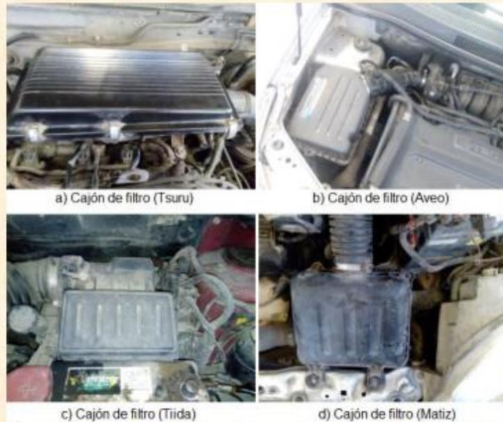
Figura 7. Ubicación del filtro purificador de aire (Satelitaxi.S.C., 2021)
