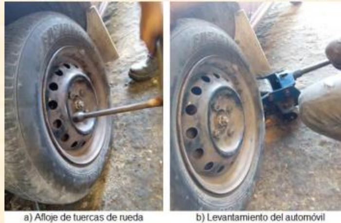
Figura 25. Levantamiento de la parte delantera del vehículo (Satelitaxi.S.C., 2021).
