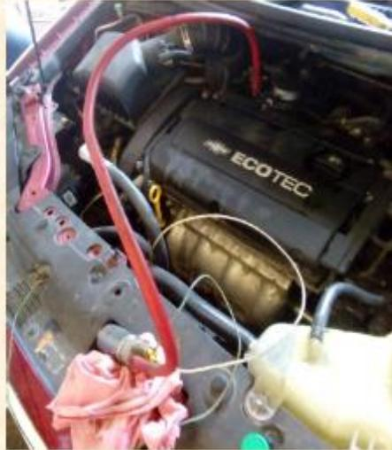
Figura 20. Conexiones para el lavado de inyectores (Satelitaxi.S.C., 2021).
