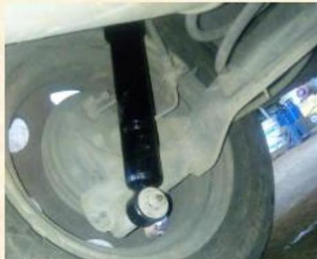
Figura 41. Colocación del nuevo amortiguador (Satelitaxi.S.C., 2021).
