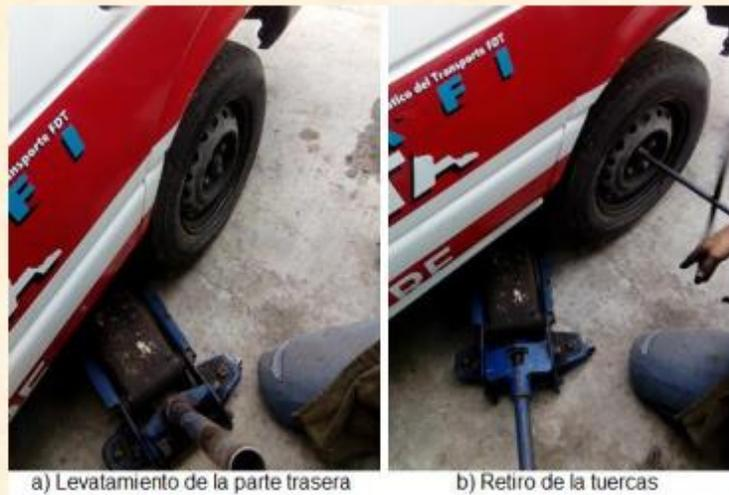
Figura 29. Retiro de las llantas traseras (Satelitaxi.S.C., 2021).
