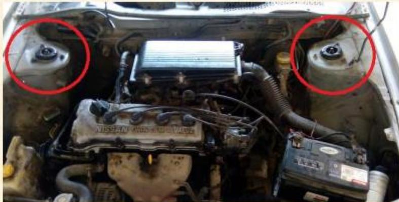
Figura 36. Tuercas de soporte del amortiguador (Satelitaxi.S.C., 2021).
