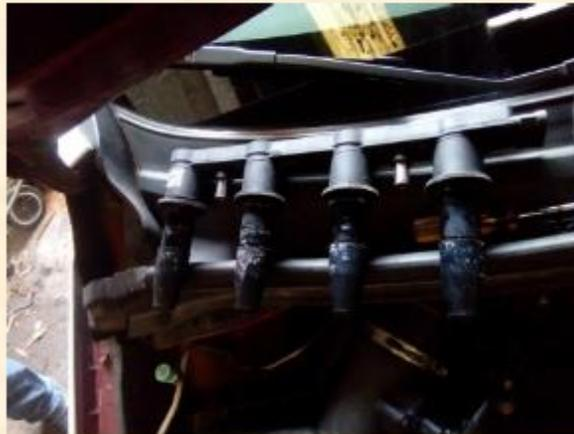
Figura 16. Bobinas (Satelitaxi.S.C., 2021).
