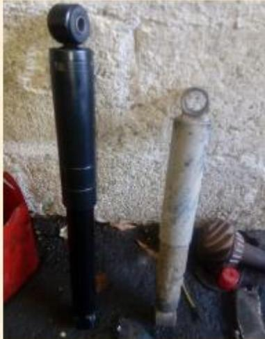
Figura 40. Comparación de amortiguadores traseros (Satelitaxi.S.C., 2021).
