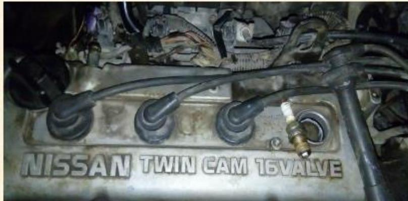
Figura 12. Desatornillado de bujías (Satelitaxi.S.C., 2021).
