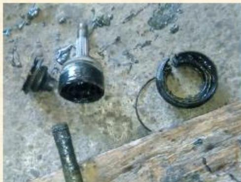
Figura 45. Separación de la bocaflecha (Satelitaxi.S.C., 2021).
