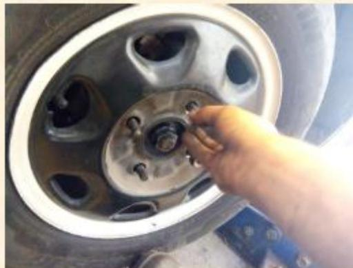
Figura 28. Colocación de la llanta (Satelitaxi.S.C., 2021).
