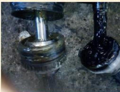
Figura 46. Comparación de lubricación de bocaflecha (Satelitaxi.S.C., 2021).
