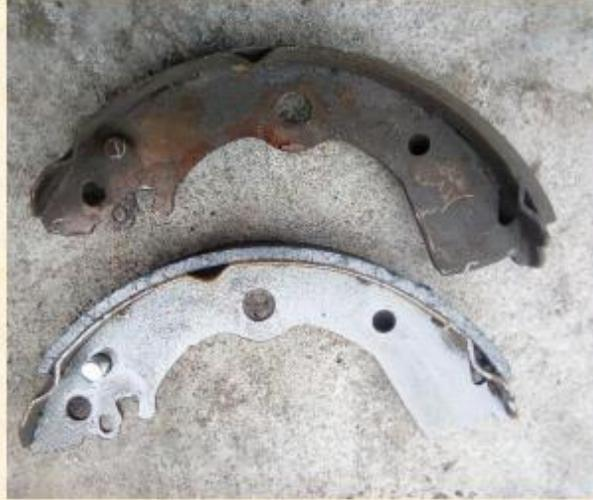
Figura 32. Comparación de balatas (Satelitaxi.S.C., 2021).
