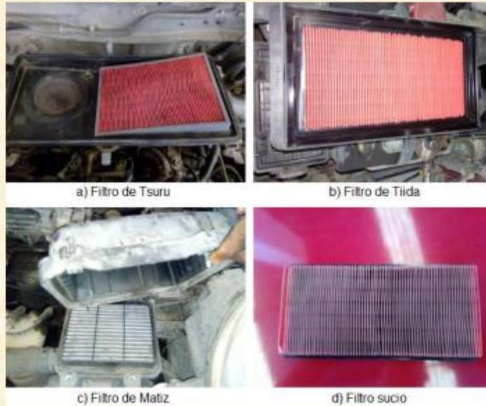
Figura 8. Tipos de filtro purificador de aire
