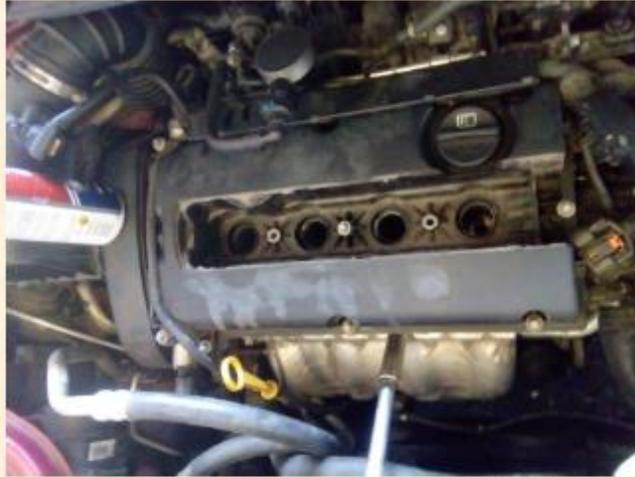
Figura 17. Colocación de bujías (Satelitaxi.S.C., 2021).
