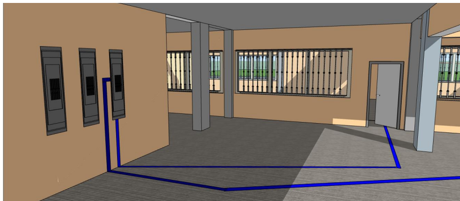
Figura 38. Tablero de Control y Conexiones Eléctricas
