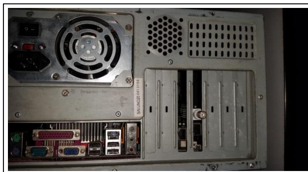
Figura 30. Tarjetas de red Instaladas.
