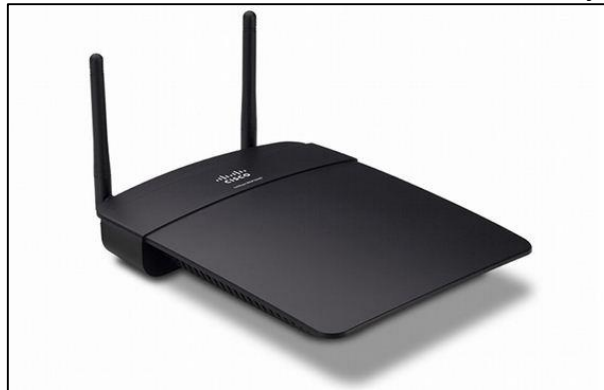
Figura 9. AP inalámbrico de doble banda N300 Linksys WAP300N.
