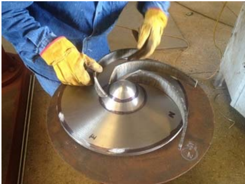
Figura 4.7 Conformado de álabes de titanio para impulsor.
