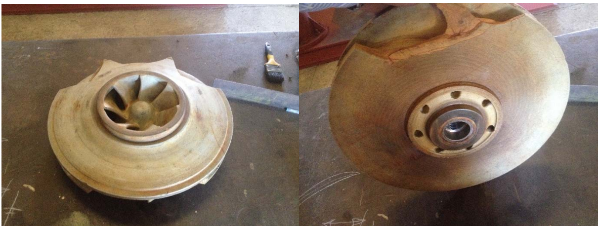
Figura 4.4 Impulsor de cerámica con ruptura en proceso de medición de las medidas base.
