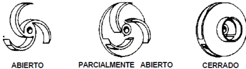
Figura 2.9 Tipos de impulsores para una bomba centrífuga.
