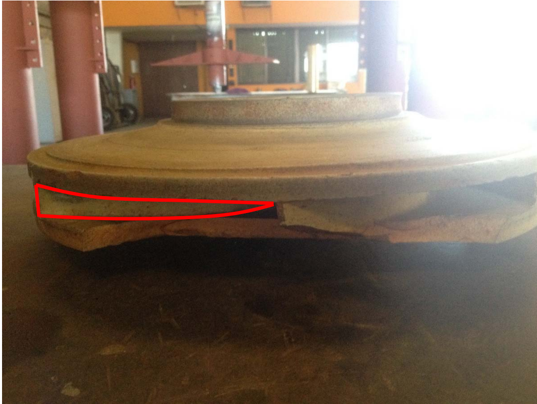
Figura 4.8 Vista lateral de impulsor de cerámica indicando zona para plantilla de medición de álabe.
