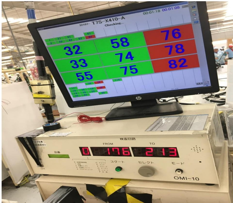
Imagen 2 Probador de arneses eléctricos, equipo traído desde Japón, este tipo de probador es determinado por el staff japonés aunque tiene modos de falla y presenta limitaciones en su funcionalidad. Foto por Eduardo Trujillo.
