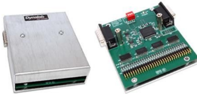
Imagen 38 Muestra del módulo de LEDs usado para transmitir las señales de iluminación. Imagen de manual de Dyalab.
