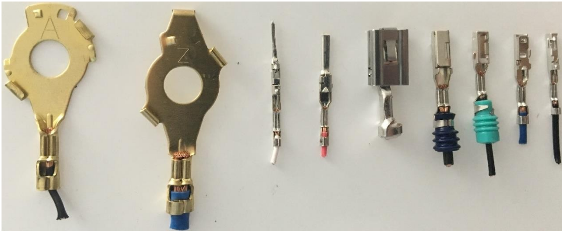
Imagen 6 Tipos de terminales que se insertan en los conectores a lo largo de la construcción del arnés en la planta Furukawa Acámbaro. Foto por Eduardo Trujillo.
