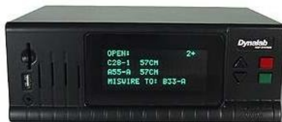
Imagen 3 Probador Dynalab es un testeador de origen norteamericano y el cual es más seguro, versátil y con menos modos de falla, es el probador que reemplazara el probador OMI. Foto de manual Dynalab.
