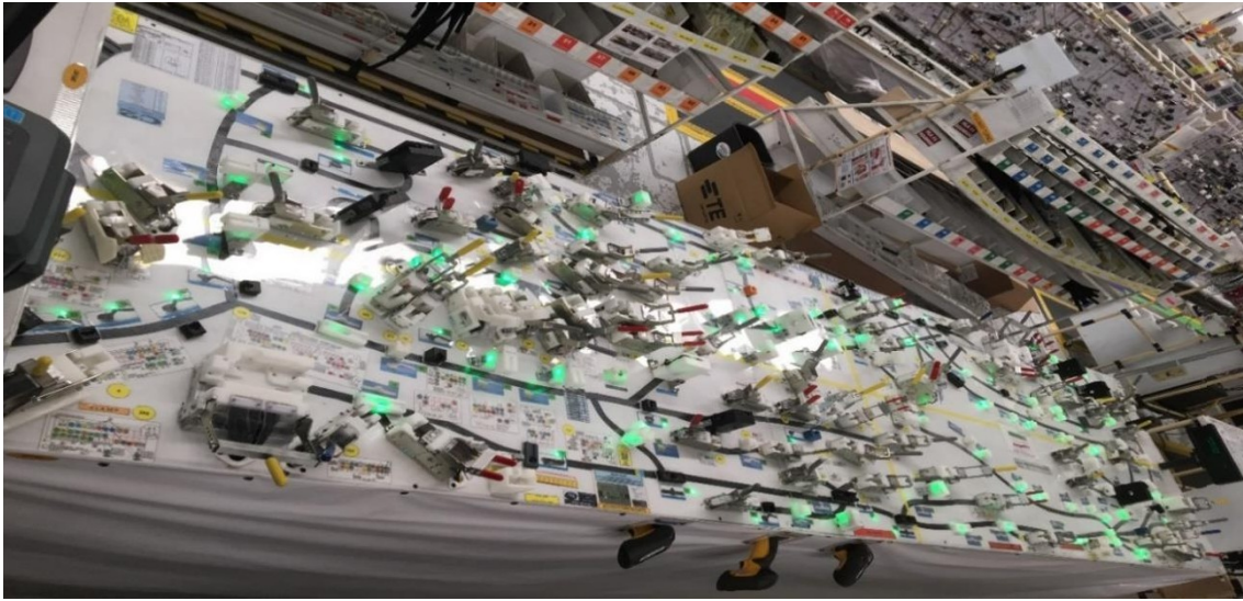
Imagen 54 Tablero de prueba eléctrica actual, liberado y colocado en línea de producción, con número de parte "X" cargado, vista superior izquierda. Foto por Eduardo Trujillo.
