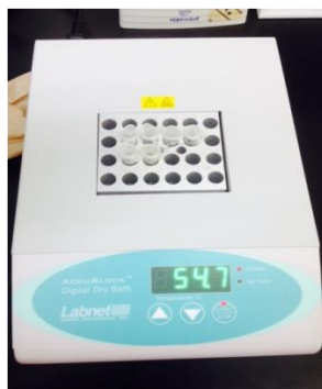
Figura A6. Incubación de muestras en un baño seco digital de la marca Labnet.
