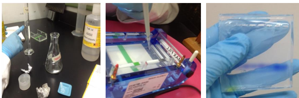
Imagen A 12. De izquierda a derecha, equipo y reactivos para gel de agarosa, llenado de pozas para electroforesis, gel-resultado de la electroforesis.
