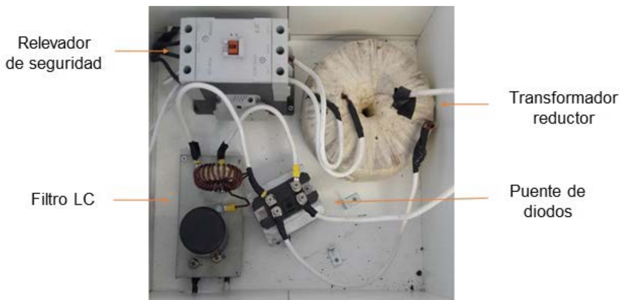
Figura 3.1 Etapas de fuente de V_{CD} de 70 V y 100 A de salida.
