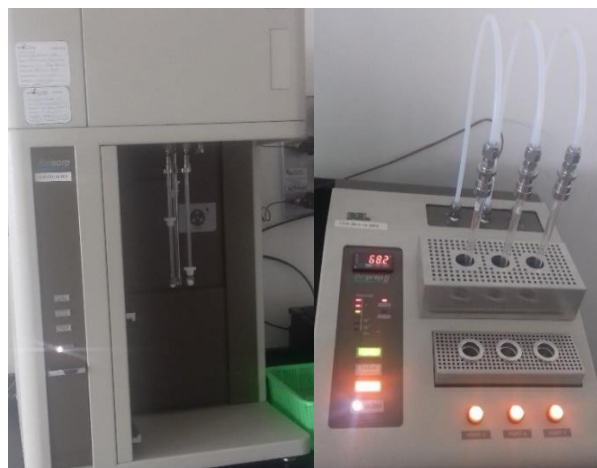
Figura 2.4 Medidor de área superficial y volumen de poro.
