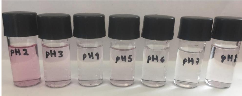
**Figura 3.15** Soluciones residuales de la adsorción del colorante respecto al efecto de pH de la solución con el hidrogel Q-TPP IRR a 35V, 30min
