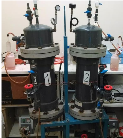
Figura 3.9 Biorreactores Anaerobios UASB escala semipiloto.
