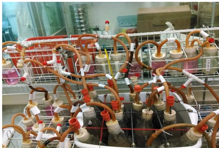
Figura 2.10. Sistema de biorreactores para prueba PBM
