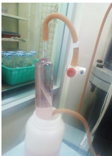
Figura 2.18 Sistema de captación de biogás.
