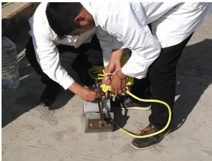
Figura 2.3. Draga para la recolección de muestras en el Río Lerma
