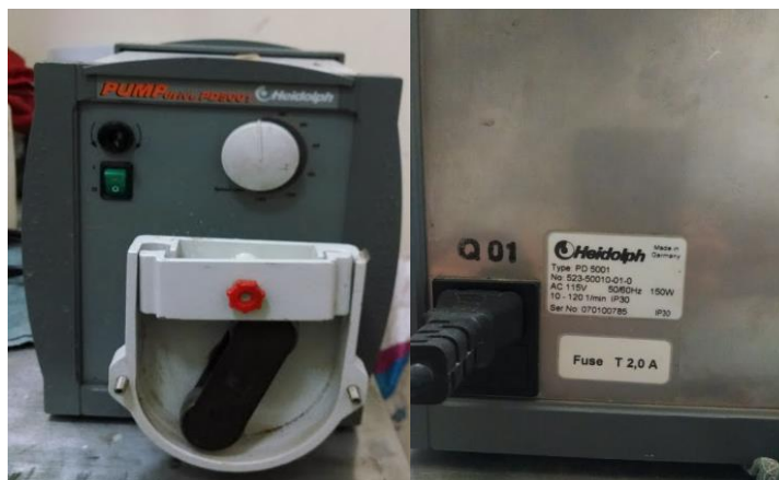
Figura 2.17 Bomba peristáltica de recirculación de lodos.
