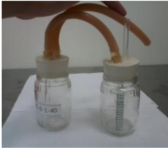
Figura A.4 Sistema de biogás
