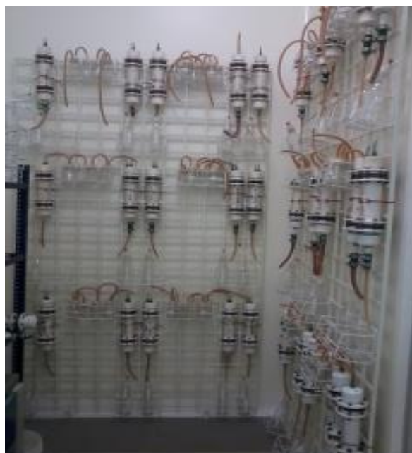
Figura 3. 8 BLAB cargados con RSU en Laboratorio de pruebas piloto.
