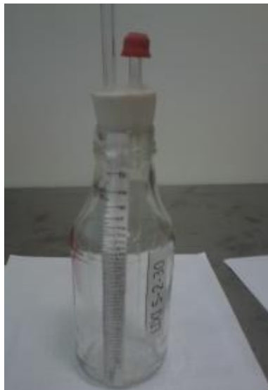
Figura A.5 Sistema para captación de lixiviados.
