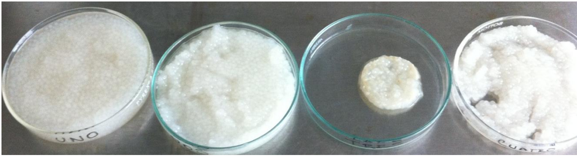
Figura 3.17. Biomasa obtenida al finalizar el tratamiento del efluente con el biorreactor airlift con P. chrysosporium libre.
