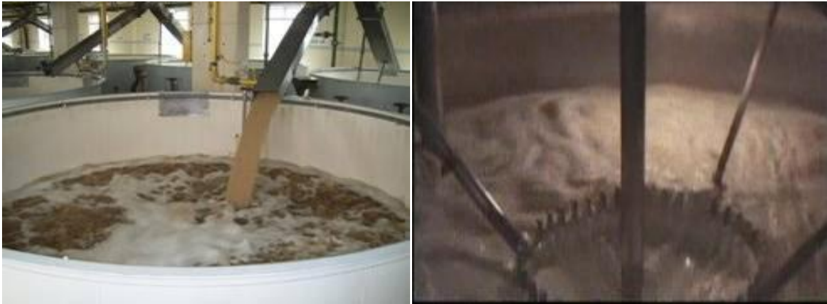
Figura 1.1. Proceso de remojo de grano (izquierda Maltería Tibito Bavaria, derecha Grupo Modelo).
