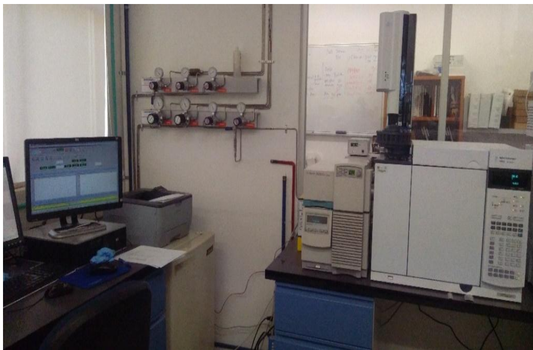
Figura 2.16 Cromatógrafo de Gases- Espectrometría de Masas, IQN utilizado en el análisis químico de POC y BPC.
