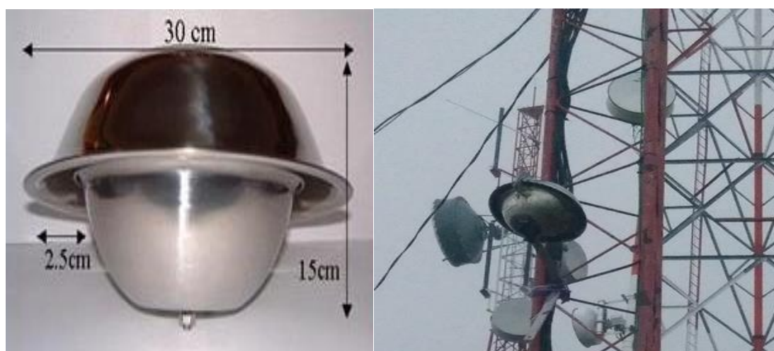
Figura 2.2 Muestreador pasivo PAS colocado en el Nevado de Toluca, México.
