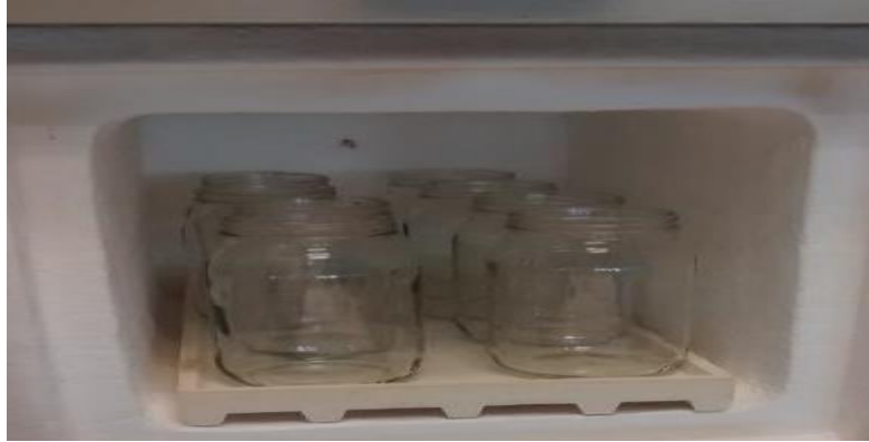
Figura 2.4. Secado de frascos de vidrio para la colecta de POC y BPC.
