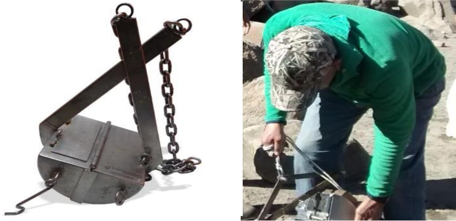
Figura 2.7 Colecta de sedimentos con una draga tipo Van Veen.
