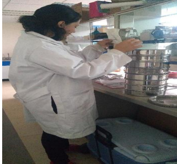
Figura 2.10 Trabajo realizado en el Laboratorio de Membranas para el análisis granulométrico en muestras sedimentarias de lagos en estudio.
