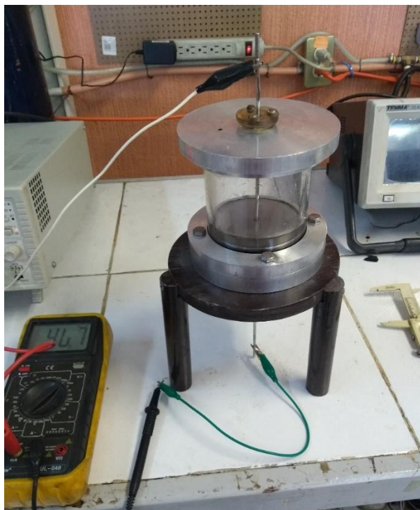
Figura 2.2. Ensamble del reactor para la síntesis electroquímica.
