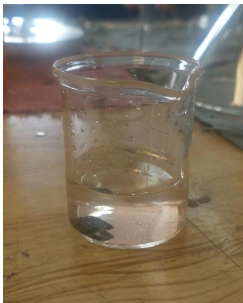
Figura 2.9. Laminilla de acero inoxidable con película de PPy/I en ácido sulfúrico.
