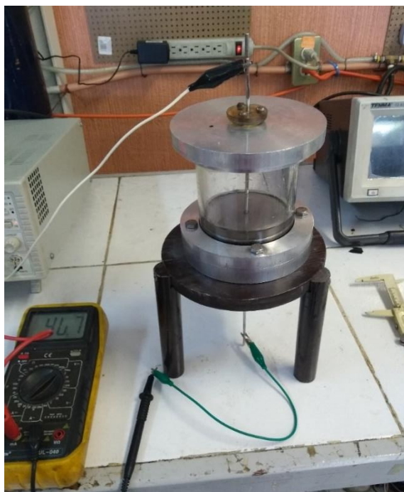
Figura 2.4. Conexión eléctrica para la síntesis de la película de PPy/I.
