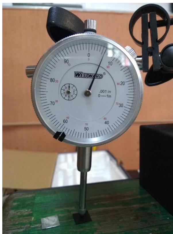
Figura 2.8. Comparador de carátula para obtener el espesor de las películas de polipirrol.
