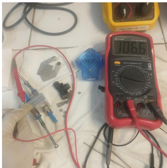
Figura 3.9. Conexión eléctrica de celda de combustible para medir su desempeño.
