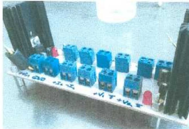
Figura 3.43 Fabricación de la tarjeta de acondicionamiento de señales.
