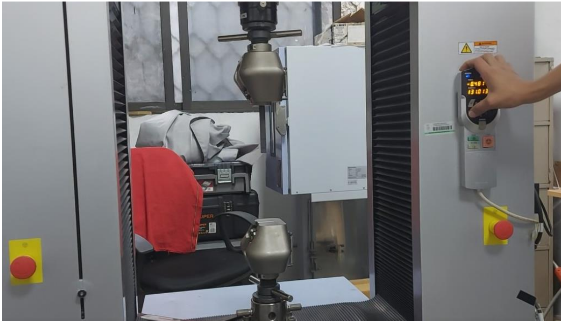
Figura 4-7.- Máquina de ensayos universales Shimadzu AG-X plus 100 kN.
