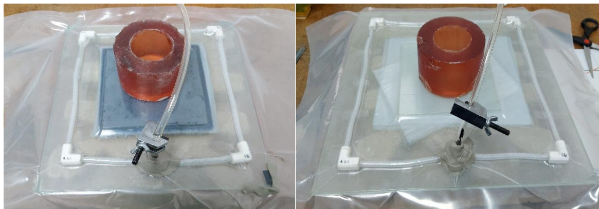
Figura 5-1.- Laminados de carbono y vidrio montados sobre molde de vidrio sellados al vacío por medio de tuberías.
