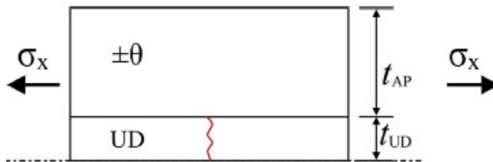
Figura 6-5.- Relación de espesor de las capas UD y \pm\theta del modelo de Jalalvand et al [1] considerando los valores del plano medio del laminado.
