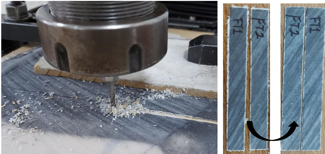
Figura 5-2.- Probetas para las pruebas a tensión del laminado [26_2/0_4/26_2] .
