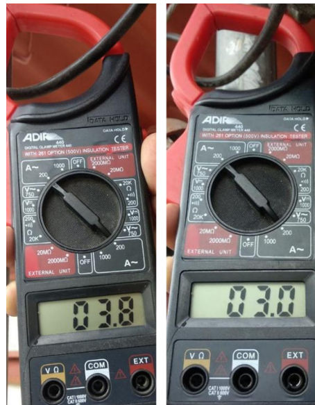
Figura 4.8: Comprobación de Consumo con Amperímetro de Gancho Radio Club S.A de C.V Ubicación Quintana Roo y Jazmín
