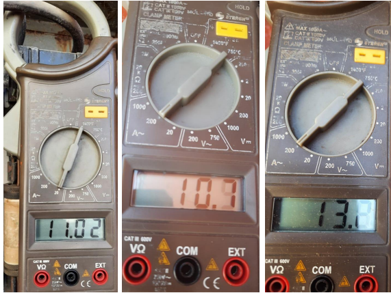
Figura 4.5: Comprobación de Consumo con Amperímetro de Gancho Radio Club S.A de C.V Ubicación Carretera Halliburton
