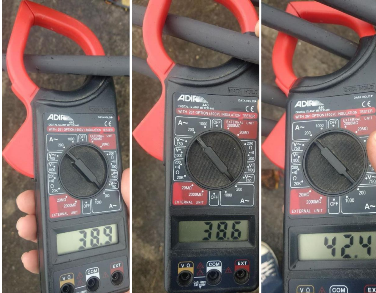
Figura 4.1: Comprobación de Consumo con Amperímetro de Gancho Radio Tajin S.A de C.V Ubicación Enrique Contreras
