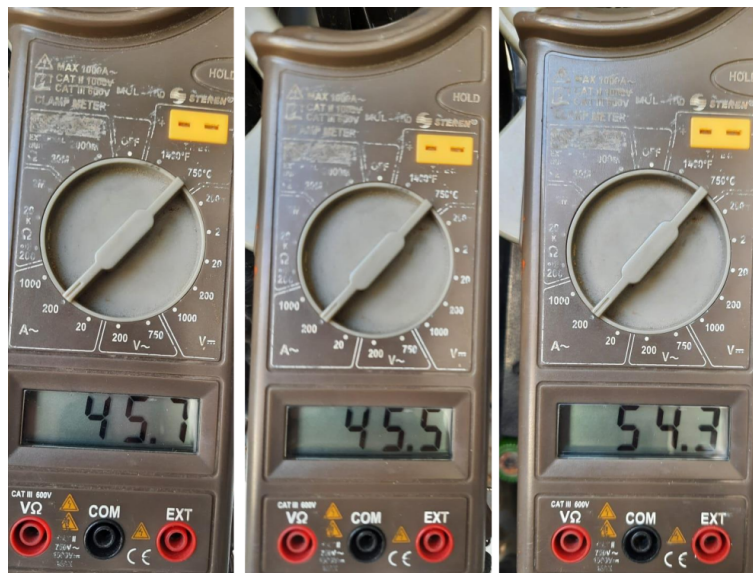
Figura 4.4: Comprobación de Consumo con Amperímetro de Gancho Compañía Radiofónica de Poza Rica Ubicación Oscar Torres Pancardo
