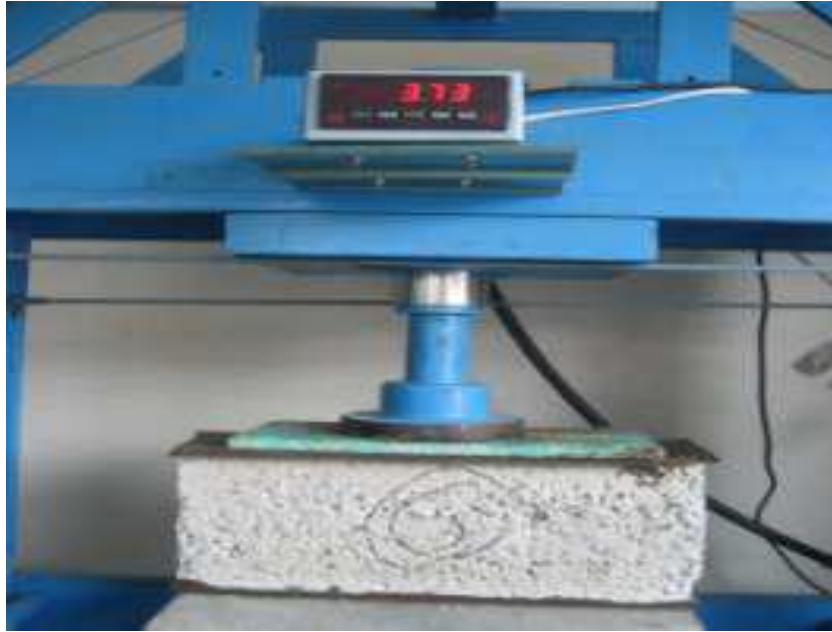
Ilustración 10: Prueba de resistencia a la compresión
