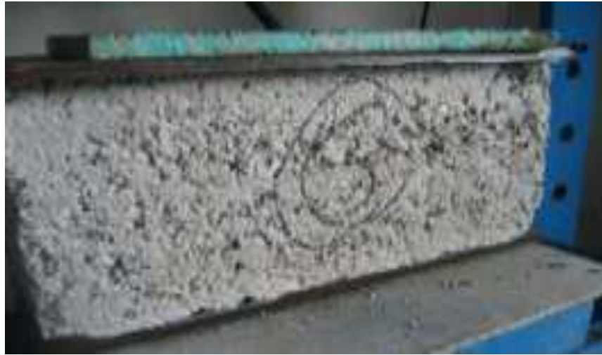
Ilustración 9: Block roturado por la fuerza de compresión
