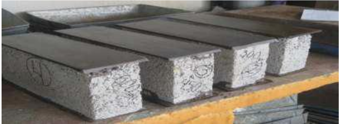
Ilustración 7: Block cabeceados para su roturación
