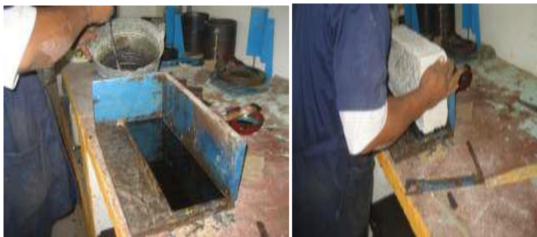
Ilustración 6: colocación del block en el molde
