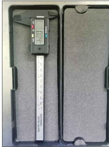
Figura 10. Vernier digital utilizado para medición de semilla. Fuente: Elaboración propia.
