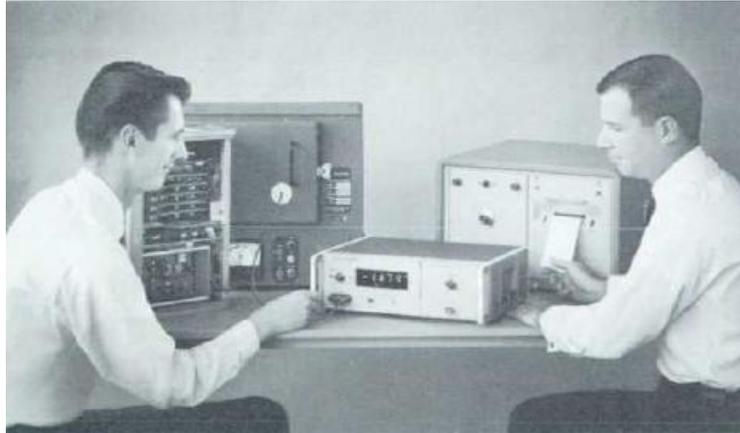
Fig.1.5 Trabajando un DVM HP-3440A conectado a una impresora para llevar el registro de un voltaje de un circuito.
