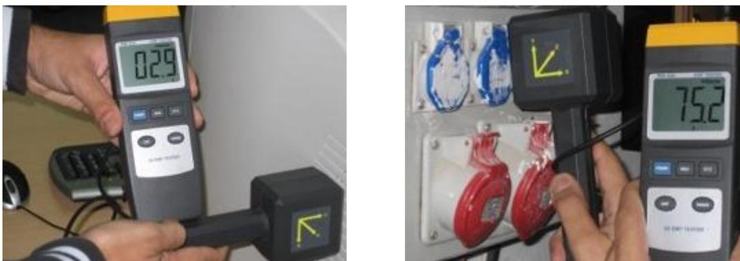
En las imágenes que aparecen en la parte superior, podrá ver como el teslámetro PCE-G28 realiza un test de la radiación emitida por un monitor y un centro de carga eléctrico. Por medio de su sonda triaxial, este teslámetro detecta las tres componentes espaciales o vectoriales del campo magnético. La radiación magnética es la componente de la radiación electromagnética que más puede afectar al ser vivo.
