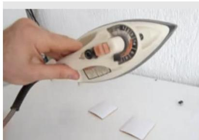
Empieza el proceso de planchado. Colocamos sobre la placa papel periódico para evitar que se queme el circuito.
