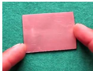
Una vez que se ha limpiado y lijado adecuadamente la lámina separada, se fija con cinta adhesiva el patrón de papel albanene sobre su superficie.
