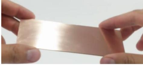
c) Planchado. Se inicia la colocación del circuito a imprimir sobre la superficie de la placa. Debe cuidarse de no tocar con los dedos la cara impresa con el toner ni la superficie de cobre.
