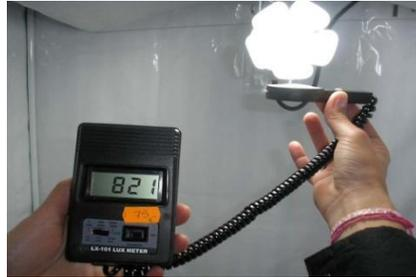
4. Para «retener» una medición, deslice el interruptor de retención de datos «Data Hold» a la posición «hold». La lectura se «congelará» en pantalla hasta que suelte el interruptor de retención de datos «Data Hold».
