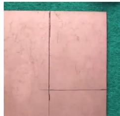
**Séptimo paso.** Cortar la placa de cobre al tamaño necesario (100x90 mm).
