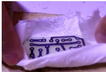
Ya lavada la placa se seca con un paño o con una servilleta de papel. Para limpiar o remover el toner de las pistas, necesitamos acetona o removedor de esmalte para uñas.
