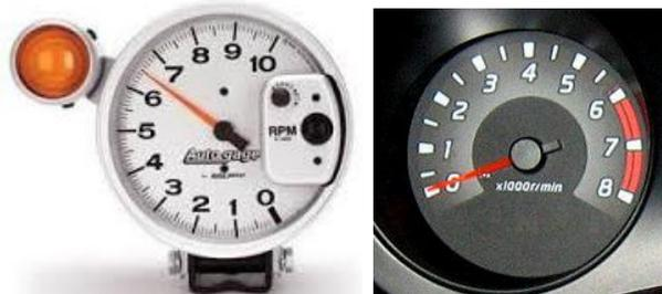
Tacómetro de un automóvil
