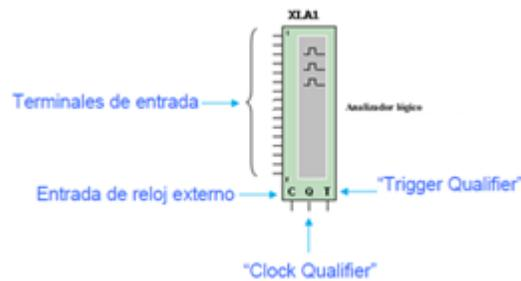
Figura 4.15 Icono del analizador lógico en MULTISIM
