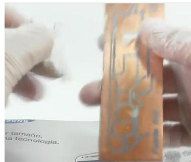
Al revisar el papel desprendido se observa que hay parte de toner que no se adhirió al cobre. Este detalle deberá ser corregido remarcando con el marcador de tinta permanente.
