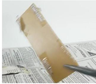
Dejamos enfriar las tarjetas. Se sumerge la placa en un recipiente con agua. Remojar las tarjetas de 10 a 15 minutos.
