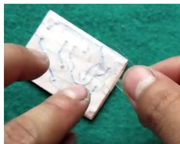
**Octavo paso.** Perforación de puntos de referencia con el punzón.
