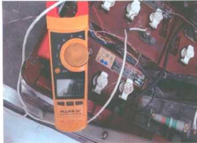
Figura 6.21 Corriente de batería en modo carga con convertidor reductor-elevador, panel fotovoltaico y MPPT
