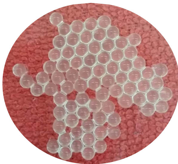
Figura 15.- Esferas de Alginato de calcio con lacasas de T. hirsuta Bm2 entrecruzadas con glutaraldehído
