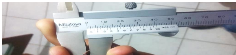
Figura 14. Imagen de autoría propia de la medición del diámetro de u cable con un calibre.
