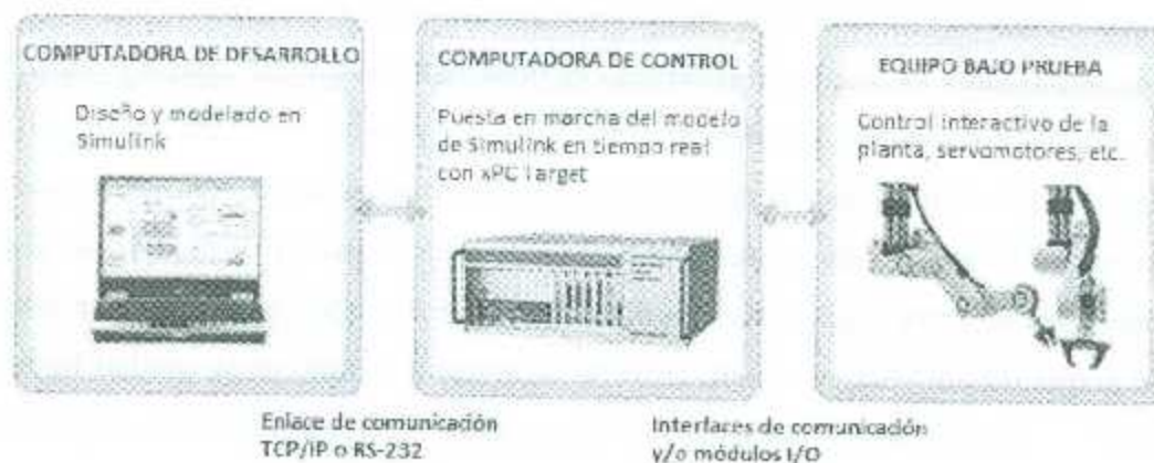
Figura 6.1: Componentes de un entorno de prueba xPC Target
