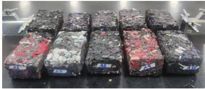
Figura 17. Tabiques de muestra tipo A.
