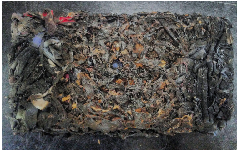
Figura 21. Prueba de inflamabilidad: Radio de quemado.
