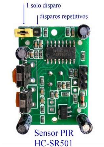
Figura 19. Jumper de señal del sensor
