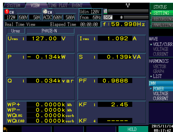
Fig. 42. FP obtenido en pruebas experimentales del medidor de calidad de energía.
