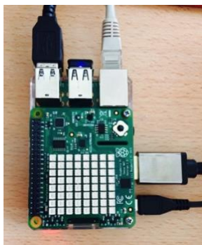
Figura 15 Raspberry pi 2 con sense hat 1.0 (Raspberrypi, s.f.)
