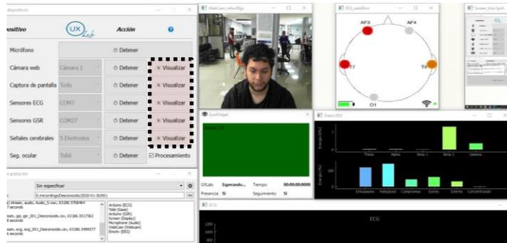
Figura 17: Monitoreo en tiempo real de sensores en UXLab. Se muestra al interior de la línea punteada las opciones que habilitan el monitoreo de los sensores en UXLab.
