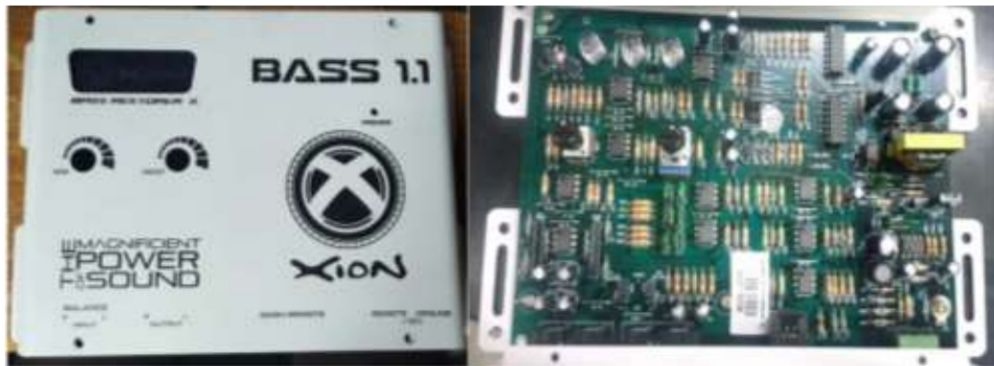
Figura 7. Desarmado de caratula y análisis de componentes.
