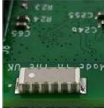
Figura 15. Antena cerámica del wifi y bluetooth de la Raspberry Pi
