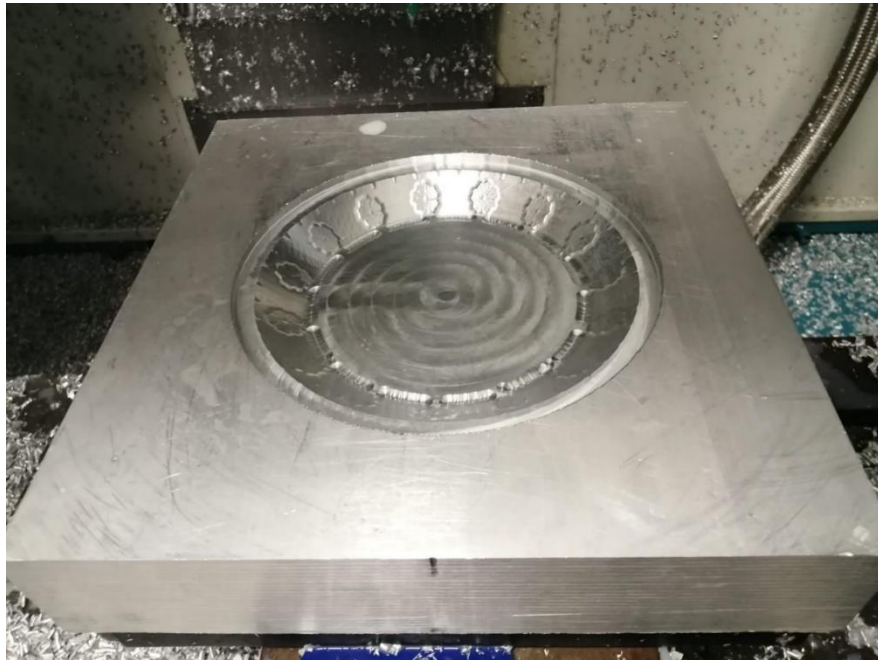
Figura 108. Operación de acabado de parte central curva molde B Fuente: (Autores)
