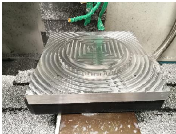
Figura 104. Operación secundaria de desbaste Fuente: (Autores)
