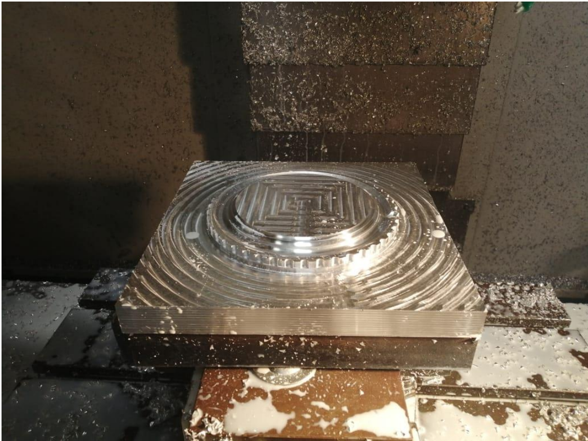
Figura 105. Operacion reduccion de material de parte central curva molde A Fuente: (Autores)
