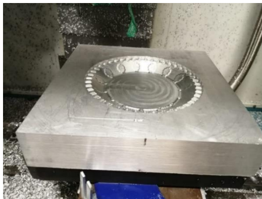
Figura 110. Operación final de acabado molde A Fuente: (Autores)
