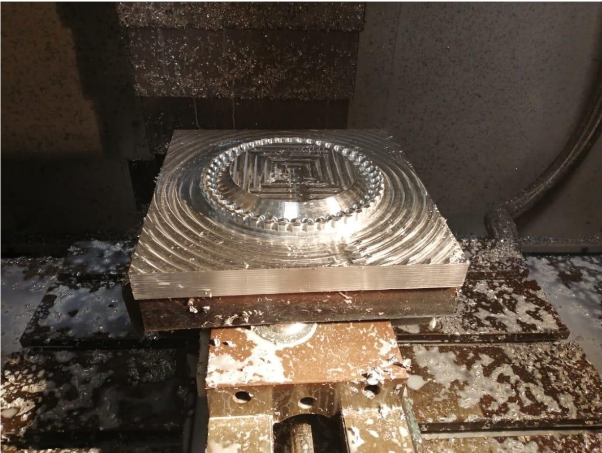
Figura 109. Operación de reducción de material para detalles molde A Fuente: (Autores)
