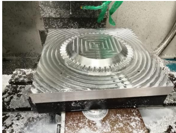
Figura 110. Operación final de acabado molde A Fuente: (Autores)
