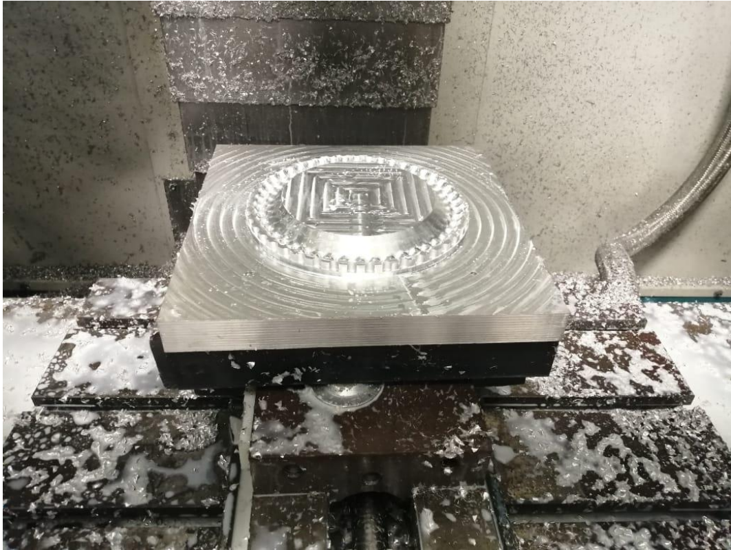
Figura 107. Operación de acabado de parte central curva molde A Fuente: (Autores)
