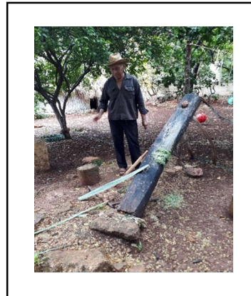
Figura 5.4 Desfibradora tradicional de henequén y su corchado mostrado por Don Hernán
