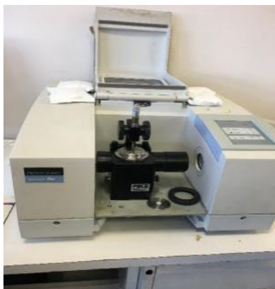
Figura 13. Equipo FTIR modelo Spectrum One marca Perkin Elmer, accesorio ATR con placa de muestra de Seleniuro de Zinc.
