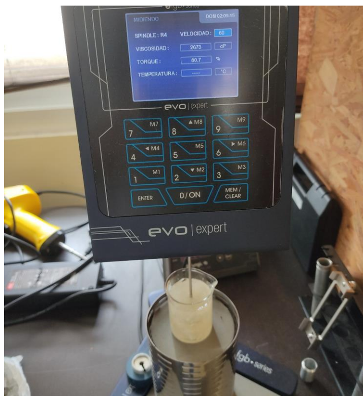
Figura 18. Determinación de Viscosidad Dinámica de la mezcla Quitosano-Alginato-CaCl 2 .
