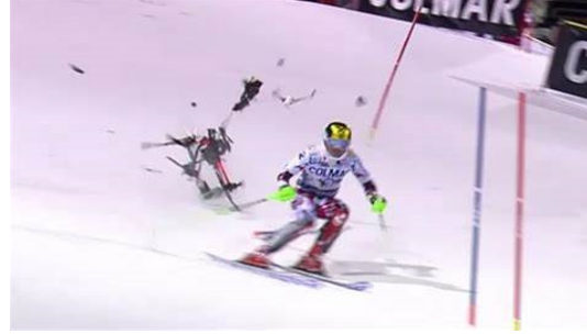
(d) Quad-rotor crashing due to actuator failure
