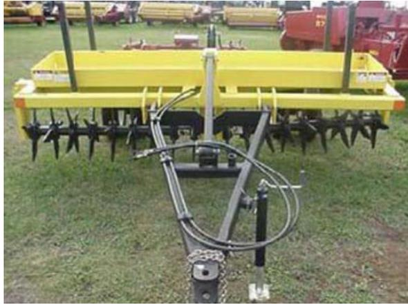
Figura 4 Vista de la maquinaria correspondiente a un renovador de praderas de acción vertical. Robinson et, al. 2000.
