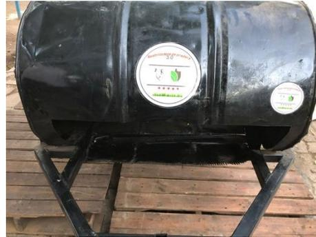
EL canal cuenta con una inclinación por donde se va a transportar la semilla apoyando el movimiento por la vibración efectuada por la máquina.
