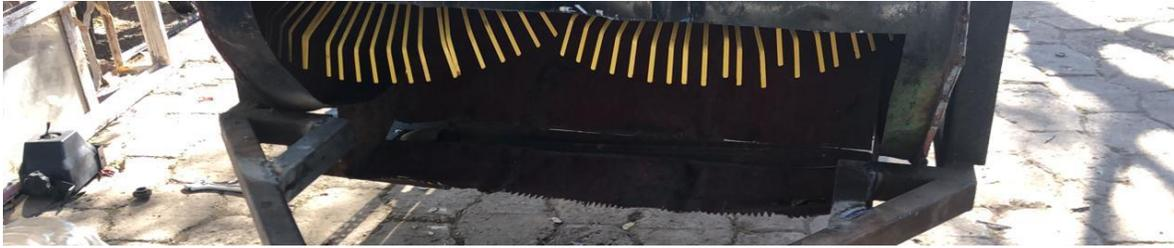
*Figura 17 Modificación del tubo que obstruía la entrada de pasto.*
