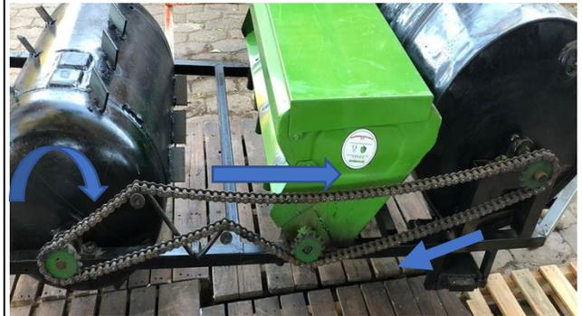
Del rodillo aereador es de donde se obtiene la fuerza para darle el movimiento a la cadena la cual está conectada a la sembradora y recolectora de semilla.
