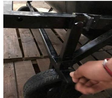
Cuando queda libre el brazo, este se eleva y se sostiene el perno 1 con el orificio 1.
