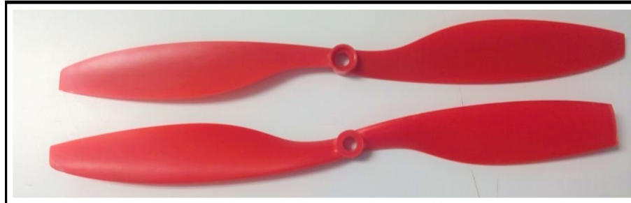
Figura 3.6: Hélice sin fractura y hélice con dos centímetros de desprendimiento.
