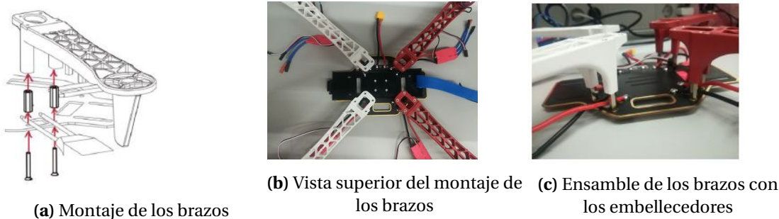
Figura B.8: Descripción y montaje de los brazos del vehículo
