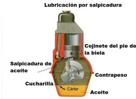
Figura 3.3: Lubricación por salpicadura
