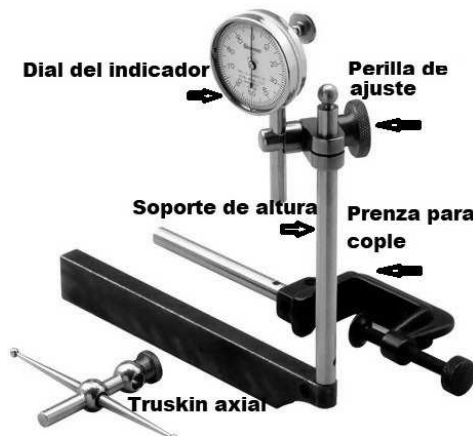
Figura 5.5: Accesorios de un indicador de carátula
