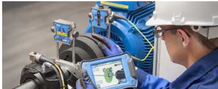
Figura 5.8: Alineación de ejes rotativos con láser
