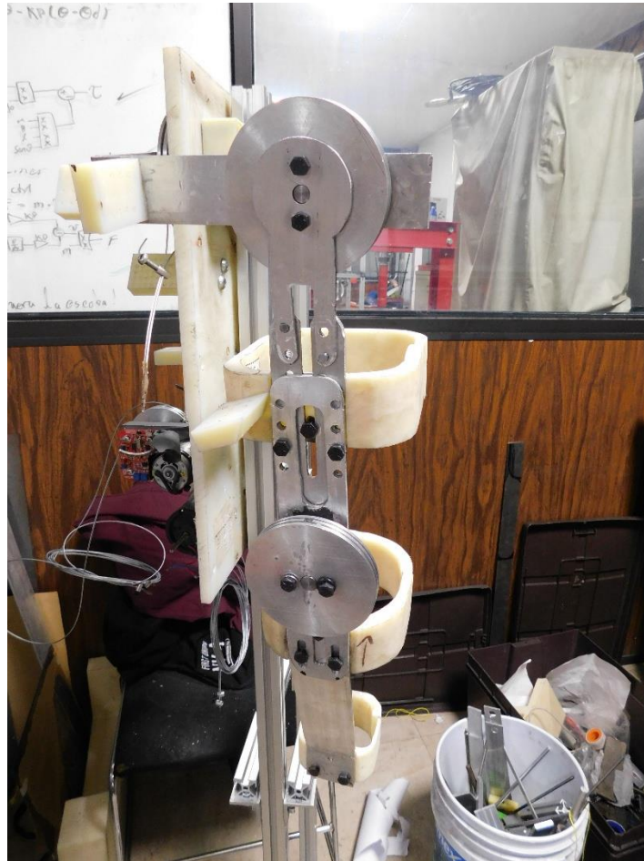
Figura 4.10. Plataforma experimental: mecanismo para emular una extremidad superior.
