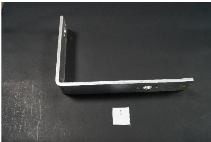
Figura 5.18. Pieza eslabón FE que soporta brazo del exoesqueleto.
