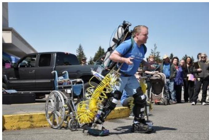
Figura 1.8. El prototipo actual LIFESUIT 14 puede caminar una milla con una carga completa y levantar 92 kg [airecomprimidokaeser.com].
