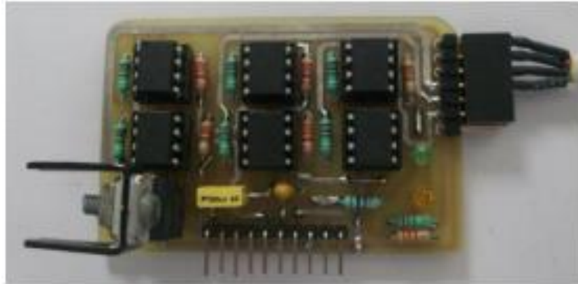
Figura 1.9 Control del inversor por medio de optoacopladores
