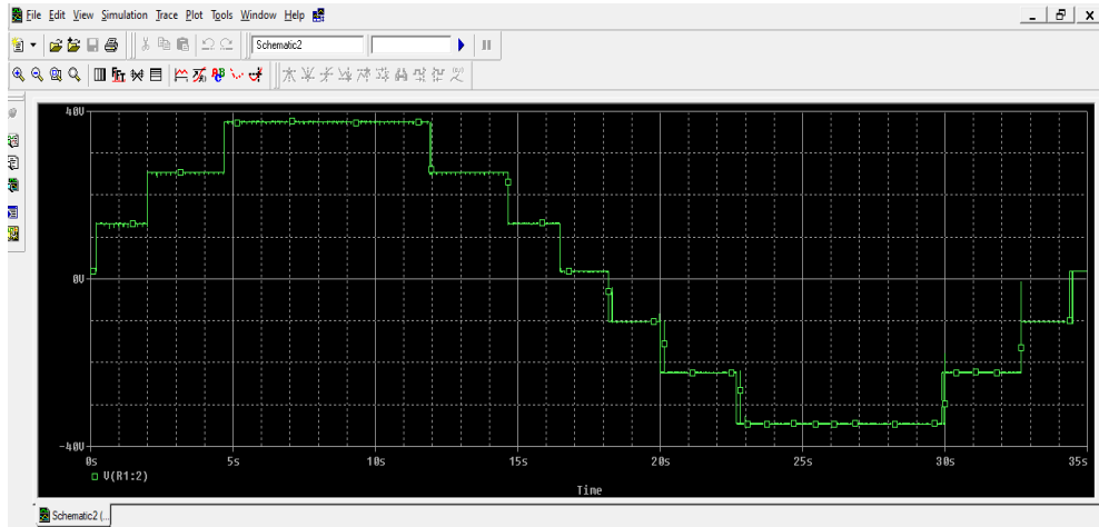
Figura 4.17 Señal senoidal de los datos del osciloscopio en el programa Pspice
