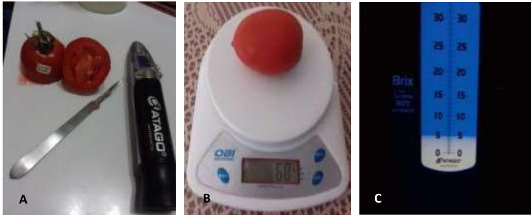
Figura 9. A) Materiales y refractómetro para medición de grados Brix, B) Peso de fruto, C) Medición y escala.
