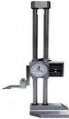
Fig. 17 Comparador de alturas con reloj.
