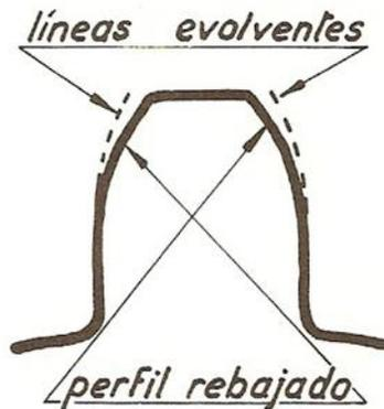
Fig. 52 Perfil de evolvente retocado, las líneas de puntos representan el perfil sin retocar.
