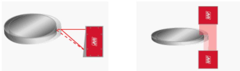
Fig. 57 Variaciones en la concentricidad de una pieza detectadas mediante sensores láser.
