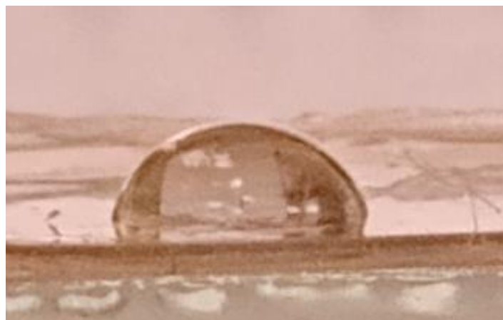
Ilustración 76 Ángulo de contacto a 40 W por 10 min. después del tratamiento UV PET.
