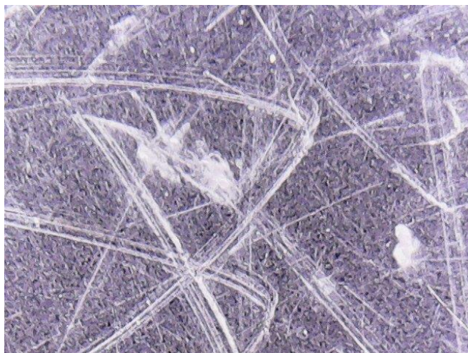
Ilustración 67 Micrografía de PET con tratamiento de plasma a 60 W con tratamiento de luz UV (creación propia).
