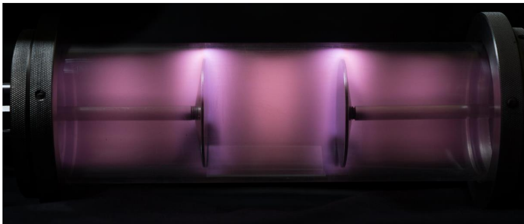
Ilustración 3. Ejemplo de plasma de resplandor (creación propia)
