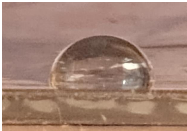
Ilustración 75 Ángulo de contacto a 40 W por 10 min. Después del tratamiento UV LDPE.
