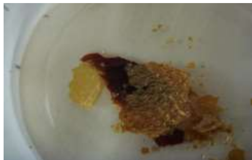
Figura 25 Película obtenida de la síntesis por plasma de PAI, fuente, elaboración propia.
