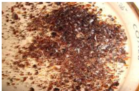
Figura 24 Material obtenido en forma de película (pulverizado debido a la fragilidad) de la combinación de PEG/PPy, fuente elaboración propia.
