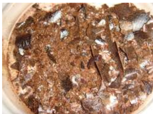
Figura 26 Película obtenida del proceso de síntesis por plasma de PAn, fuente, elaboración propia.
