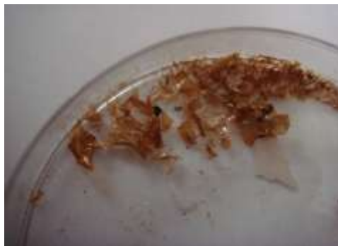
Figura 27 Película obtenida al final de la síntesis por plasma de PEG, fuente, elaboración propia.
