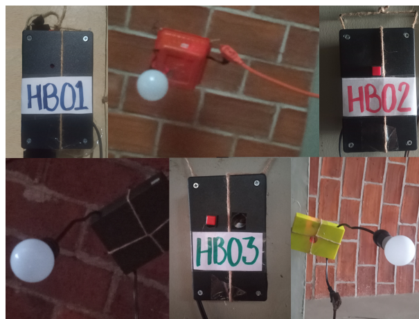
Figura 44: Sistema de iluminación con control manual.
