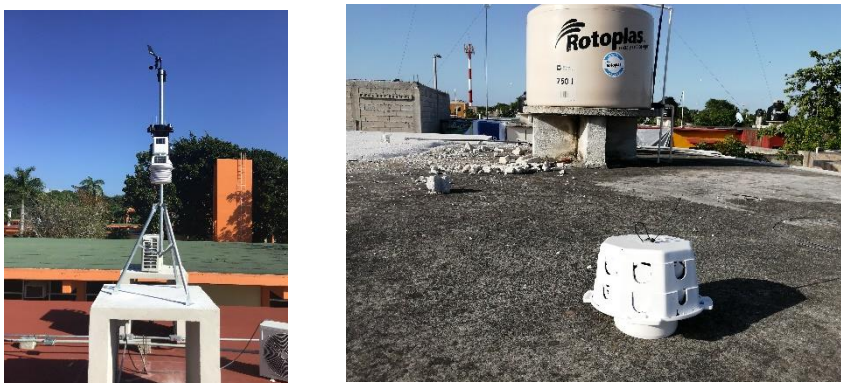
Figura 6. Estación meteorológica ubicada en el ITCH (izq.). Dispositivo HOBO con su protector solar, localizado en la azotea de caso de estudio 1 (der.)
