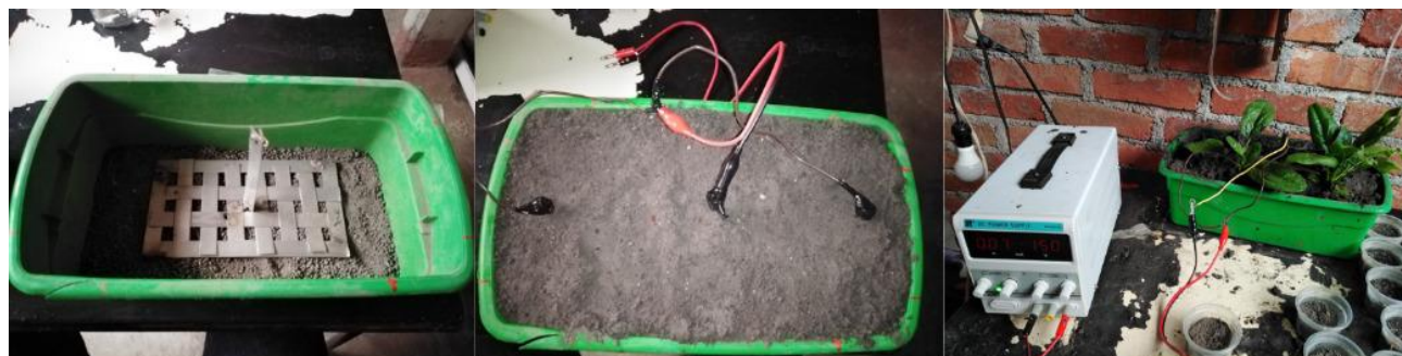
Figura 14. Acomodo e inicio de experimento de electrofitorremediación.
