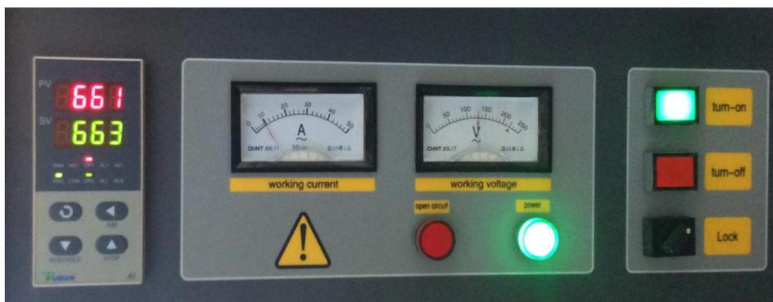
**Figura C-1** Tablero de programación del horno DEDUTEL OFT-1200x
