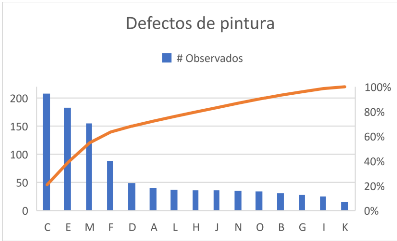
Figura 3-11 Diagrama de Pareto sobre defectos de pintura. Generado en Excel
